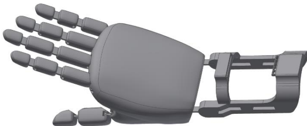
Figura 1. Ansamblul protezei realizat în softul Autodesk Inventor.
